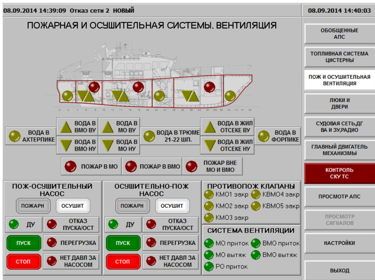
Рисунок 2.12 – Видеокادر контроля пожарной и осушительной системы
