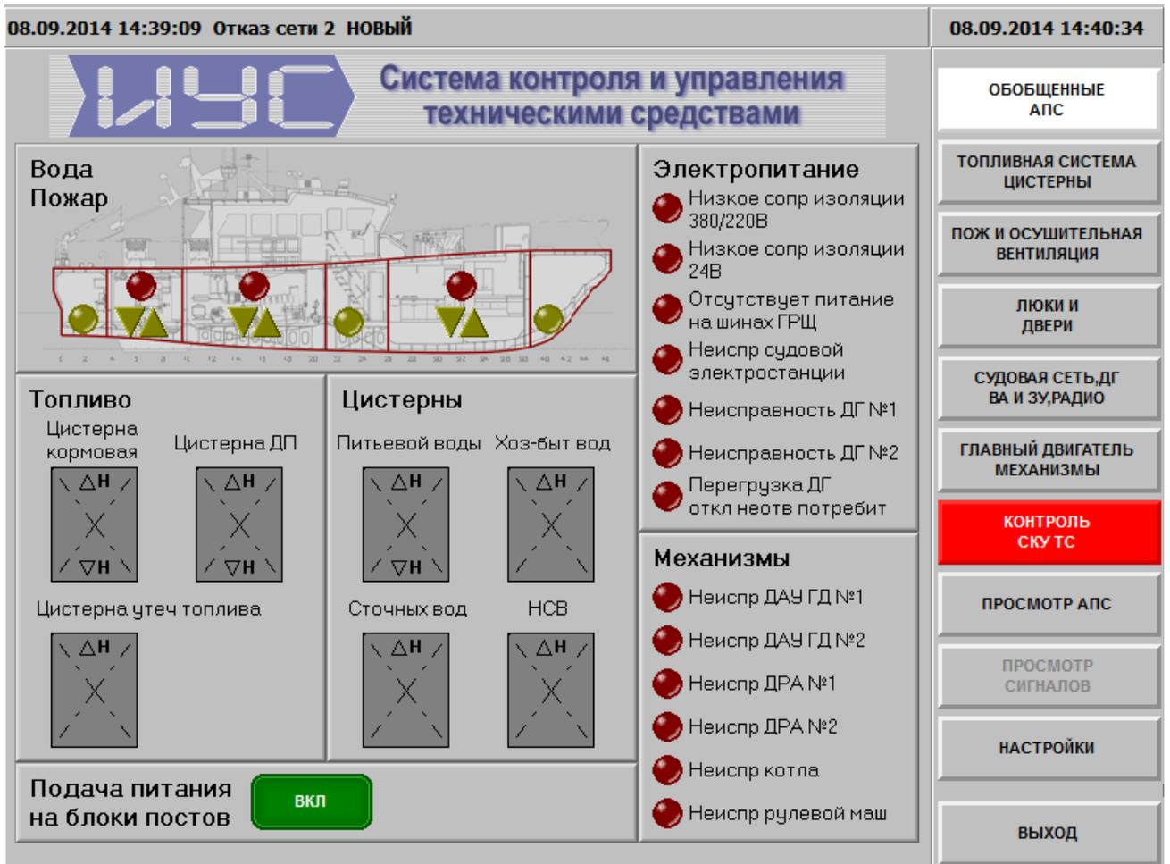
Рисунок 2.10 – Видеокадр контроля обобщенной АПС
